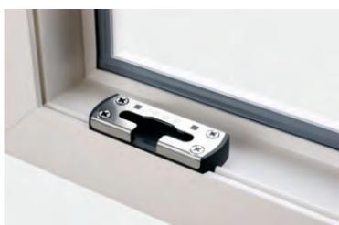
La piastra anta ribalta di sicurezza e la piastra di sicurezza sono realizzate standard in acciaio, conferendogli un elevato grado di sicurezza rispetto alle placche realizzate in zamac, materiale più fragile nel caso di tentativo di scasso con piede di porco.
